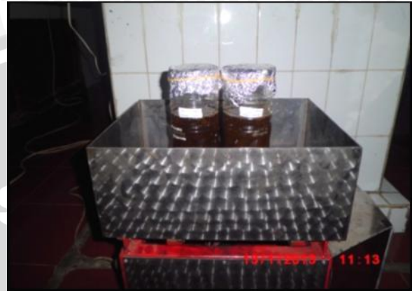
Proses maserasi dengan Shaker pada suhu ruang ( \pm 27^\circ\text{C} )
