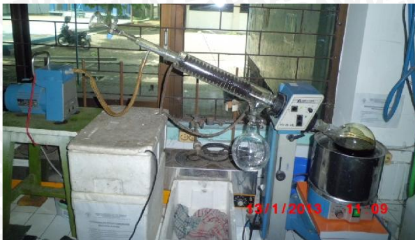
Proses evaporasi filtrate menggunakan rotary vacuum evaporator
