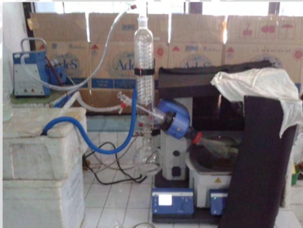
22. Pemisahan pelarut dengan sampel menggunakan alat vacuum rotary evaporator
