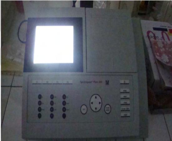
35. Proses penghitungan absorbansi sampel menggunakan Spektrofotometer UV-Vis
