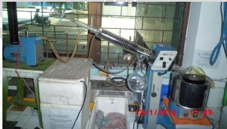
Proses evaporasi filtrat dengan rotary vacuum evaporator
