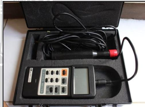
Foto Salah Satu Alat Yang Digunakan Untuk Mengukur Kualitas Air (DO Meter)
