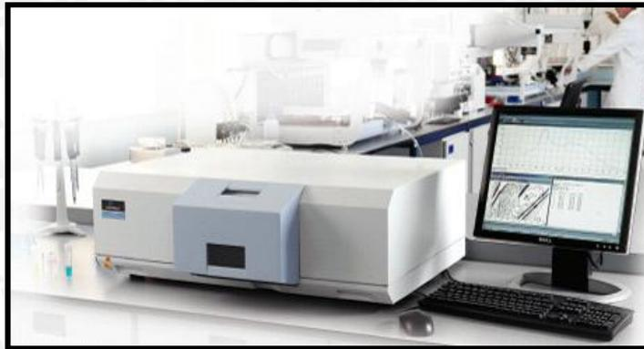
**Gambar 8.** Alat Spektrofluometri (Perkin; Elmer, 1981).
