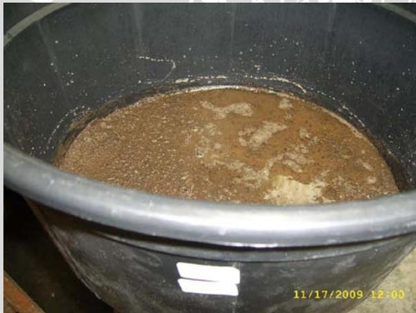
Tanah pada bak yang telah ditambahkan air dan dibiarkan selama 24 jam
