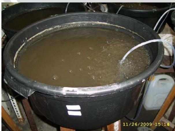
Bak kontrol yang telah dilengkapi dengan aerator
