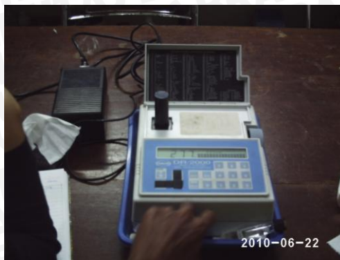
Gambar 8. Pengukuran kadar ammonia menggunakan spektrofotometer
