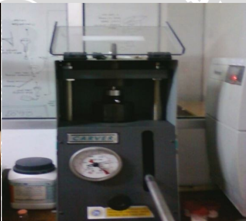
c. Pemasukan sampel ke dalam tabung pemadat d. Pematatan sampel menjadi pellet
