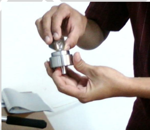
c. Pemasukan sampel ke dalam tabung pemadat d. Pematatan sampel menjadi pellet
