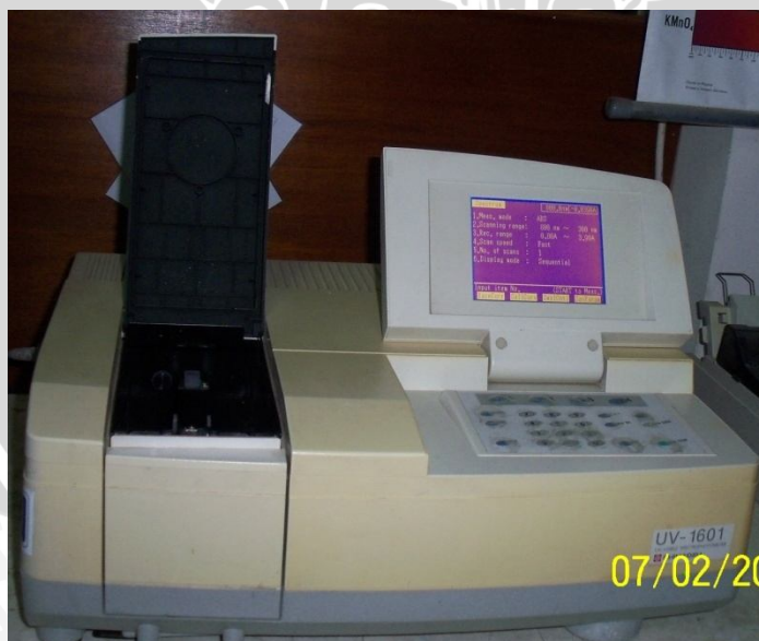
Gambar 5. Spektrofotometer UV-1601 (Sumber: Laboratorium Kimia Universitas Brawijaya)
