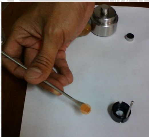
e. Bentuk sampel yang telah dipadatkan f. Proses pendeteksiangugus fungsi dengan FTIR.
