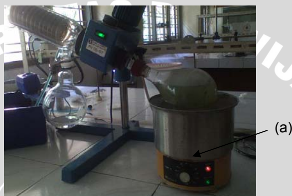
Gambar 6. Proses tahapan ekstraksi G. verrucosa Keterangan : (a) Alat ekstraktor rotary evaporator
