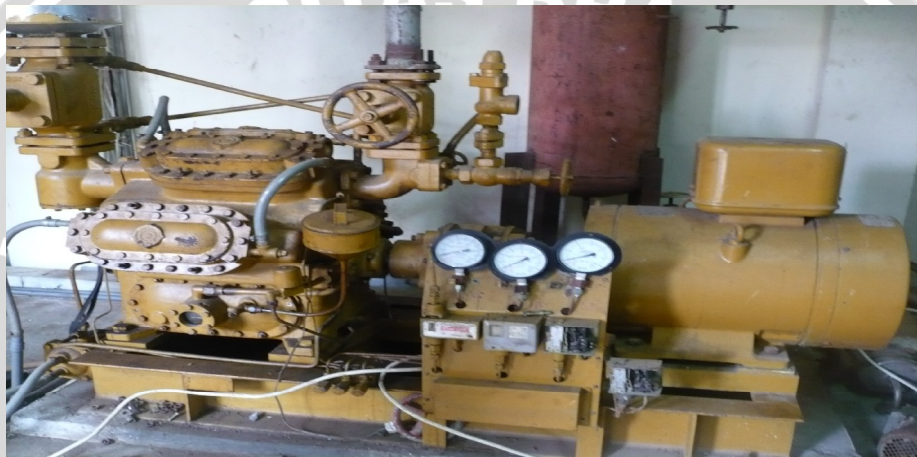
Gambar 8. Kompresor set dengan tabung sebagai motor penggerak
