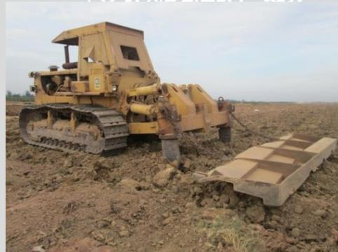
Gambar 6. Pemecahan lapisan dalam menggunakan *Subsoiler*
