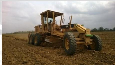
Gambar 9. Pembuatan jalan dan saluran air menggunakan *Motor Grader*
