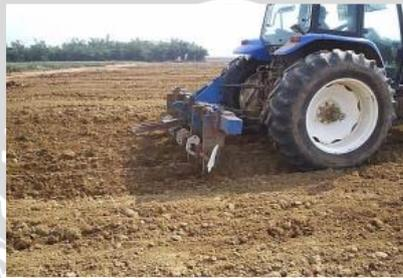
Gambar 8. Pembuatan Guludan menggunakan *Disk Ridger*
