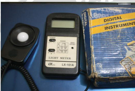
Gambar 10. Lux meter merupakan alat yang digunakan untuk mengukur intensitas cahaya matahari di dalam dan diluar naungan
