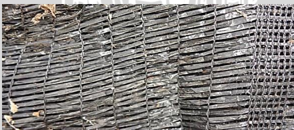
Gambar 2. Geotekstil Jenis Polypropilene (Foto: Pratiwi, 2016)
