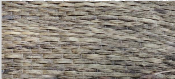
Gambar 4. Geotekstil Jenis Mendong (Foto: Pratiwi, 2016)
