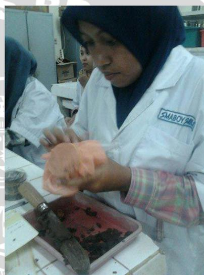
Gambar 12. Proses Analisis Kadar Air Kapasitas Lapang pF 2,5
