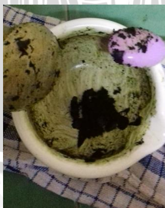
Gambar 27. Tahap penumbukan sampel daun yang diuji
