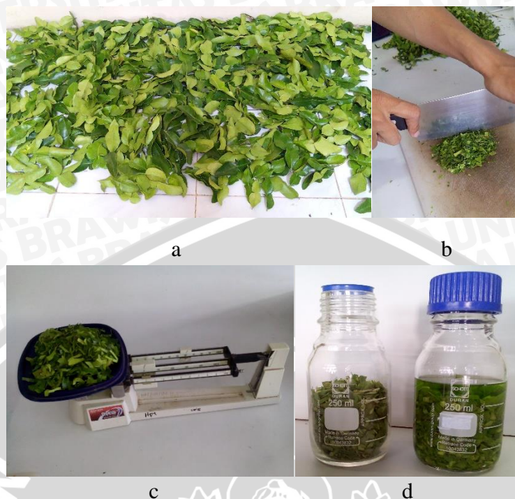
Gambar Lampiran 1. Proses ekstraksi daun jeruk purut; (a) Pengeringan daun jeruk purut; (b) Pemetongan daun jeruk purut; (c) Penimbangan daun jeruk purut; (d) Daun jeruk purut dimasukkan ke botol 250 cc dan ditambah pelarut N-Heksan
