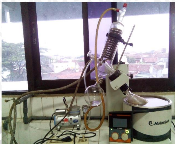
Gambar Lampiran 4. Proses pemisahan filtrat dari pelarut menggunakan Rotary Vacuum evaporator
