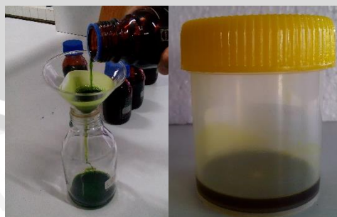
Gambar Lampiran 3. Proses penyaringan setelah digojok dan hasil ekstraksi
