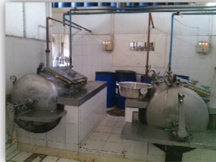
Mesin vacuum frying untuk mengolah buah salak
