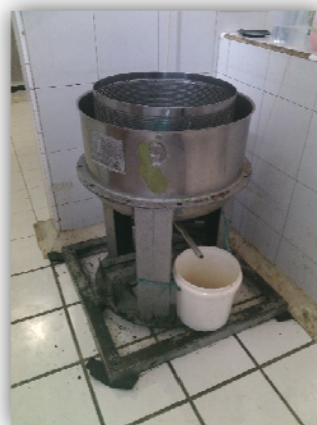
Mesin spinner untuk meniriskan keripik salak
