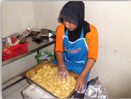
Proses pengemasan keripik salak
