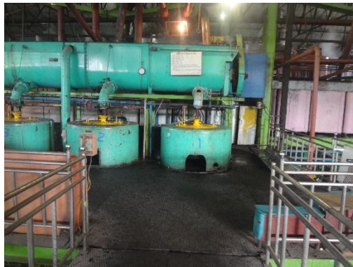
Gambar 17. Puteran Low Grade Fugal (LGF) (Sumber : Dokumentasi peneliti, 2016)
