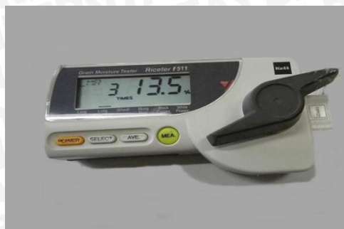
Gambar 6. Grain Moisture Tester Tipe Ricoter F511 yang Digunakan dalam Penelitian
