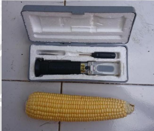
Gambar 2. Hand Refraktometer ( $^{\circ}$ Brix)
