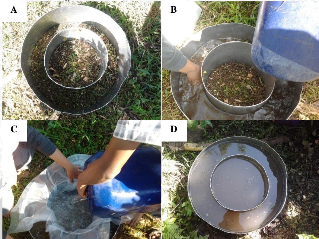
Keterangan : A (Gambar Pemasangan Double Ring ), B (Mengisi Ring Luar dengan air hingga penuh), C (Mengisi Air Ring Dalam dengan Plastik), D (Pengukuran Penurunan Air).
