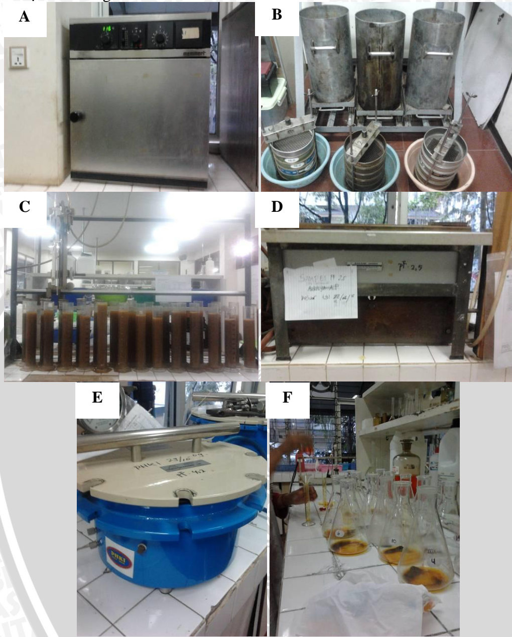
Keterangan : A (Oven : Digunakan untuk pengukuran berat kering oven), B (Analisis Kemantapan Agregat), C Analisis Tekstur), D (Pengukuran Kadar Air Kapasitas Lapang dengan pF 2,5), E (Pengukuran Kadar Air Titik Layu Permanen dengan pF 4,2), F (Analisis C-Organik untuk Memperoleh Nilai Bahan Organik).
