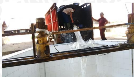
Gambar 9. Penerimaan lateks kebun di bak penampungan
