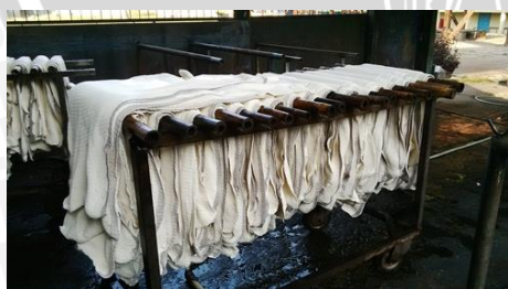
Gambar 15. Lembaran karet RSS siap untuk di ruang pengasapan
