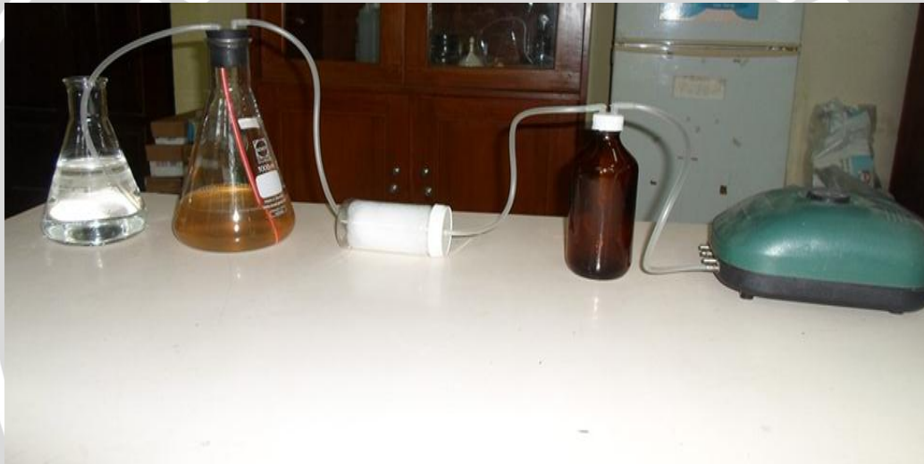
Gambar Lampiran 5. Rangkaian fermentor perbanyak M. anisopliae
