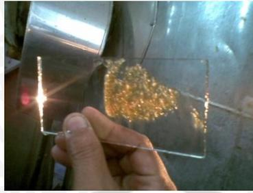
Gambar 7. Pengontrolan Kejenuhan Larutan pada Proses Masakan
