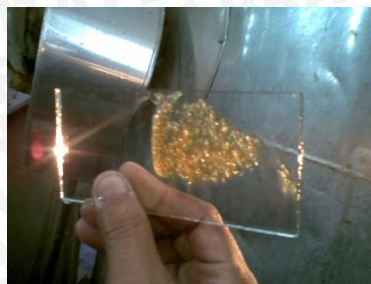
Gambar 7. Pengontrolan Kejenuhan Larutan pada Proses Masakan
