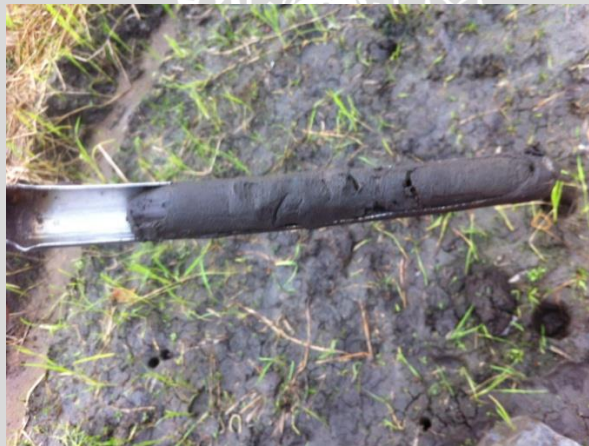
Pengambilan contoh tanah menggunakan alat lisimeter (Metode Lisimeter Mikro)
