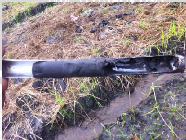
Pengambilan contoh tanah menggunakan bor (Gradien Lengas Tanah)
