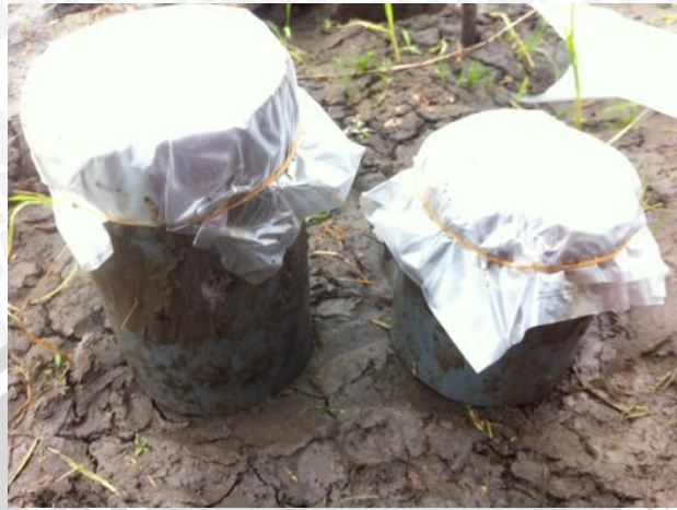
Pengambilan contoh tanah menggunakan alat lisimeter (Metode Lisimeter Mikro)
