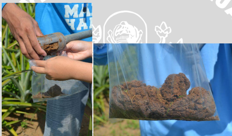
Memasukkan contoh tanah ke dalam kantong plastik untuk penanganan lebih lanjut di laboratorium (Foto oleh : Ubaidillah)
