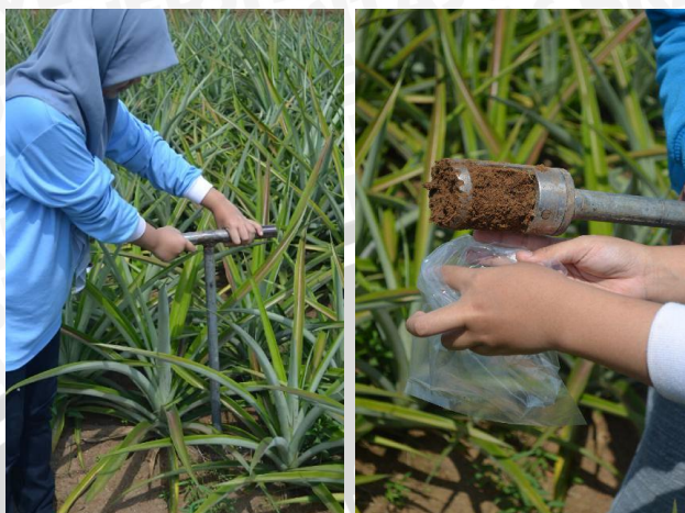
Pengambilan contoh tanah menggunakan bor tanah (Foto oleh : Ubaidillah)
