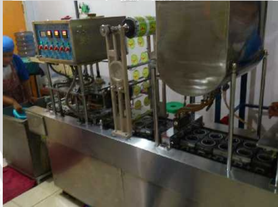
Proses produksi sari apel menggunakan mesin press cup seller otomatis
