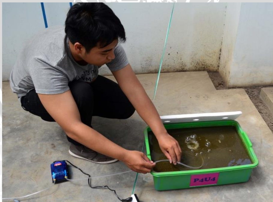
Gambar 8. Pemasangan Selang Aerator ke dalam Bak
