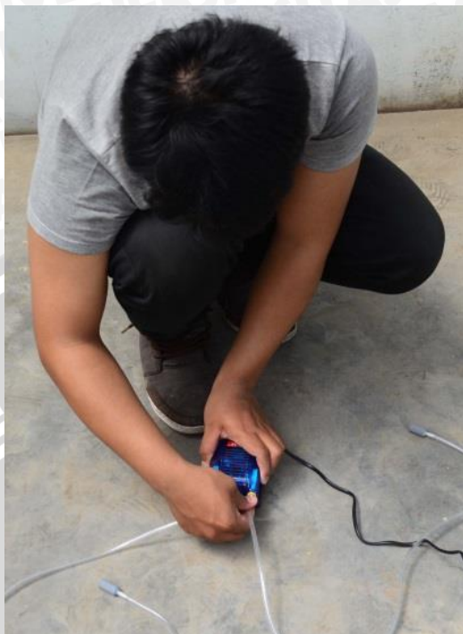
Gambar 7. Pemasangan Selang ke Aerator
