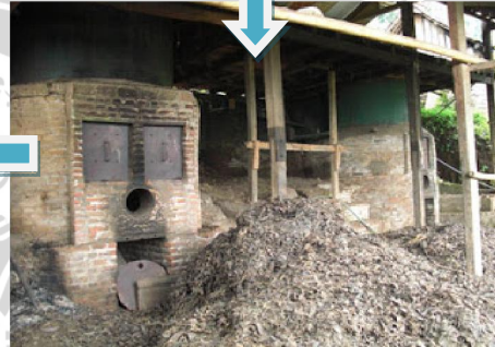
Penyulingan nilam untuk pengambilan kandungan minyak dari terna ke-ring nilam.
