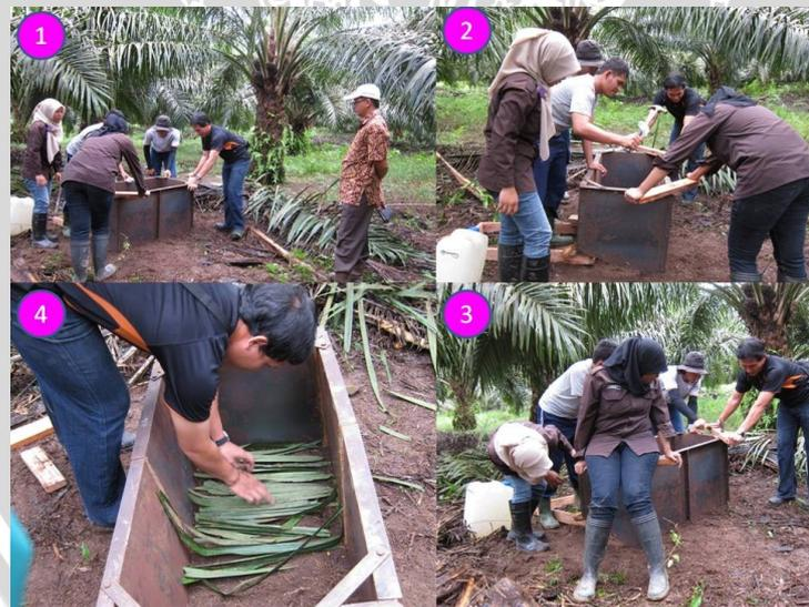
Gambar 4. Pemasangan Bingkai Besi untuk Membatasi Sebaran Larutan *Methylen Blue* ke Arah Horizontal: 1-3: Penancapan frame porositas ke dalam tanah. 4: Penutupan permukaan tanah menggunakan daun sawit (Foto oleh: Kurniatun Hairiah)
