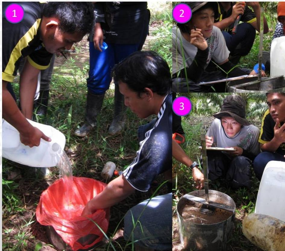
Gambar 7. Proses Memasukkan Air ke dalam Ring Infiltrometer. 1: Penuangan air ke dalam ring, 2-3: pengamatan penurunan air. (Foto oleh: Kurniatun Hairiah)
