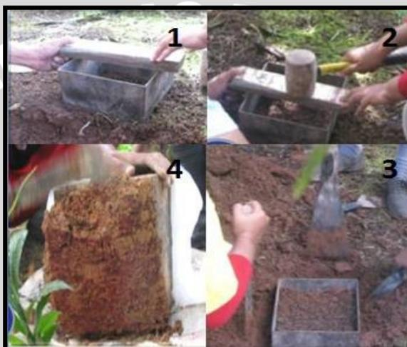
Gambar 8. Pengambilan Sample Tanah. 1: peletakan Blok BI pada permukaan tanah, 2: Penancapan blok BI menggunakan palu, 3: penggalian blok BI, 4: Pembersihan sample tanah (Foto oleh: Kurniatun Hairiah)
