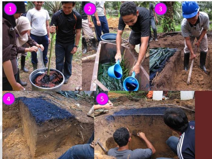
Gambar 5. Penuangan Larutan *Methylen* ke Permukaan Tanah dan Penggalian Profil Tanah: 1: Pencampuran air dengan bubuk *methylen blue*, 2: Penjuanan tanah menggunakan larutan *methylen blue*, 3: Pembukaan profil tanah di hari berikutnya, 4: Lubang profil yang telah terbuka, 5: pembersihan pori makro dari tanah. (Foto oleh: Kurniatun Hairiah)
