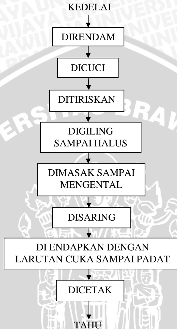
Gambar 3. Diagram Proses Pengolahan Tahu
