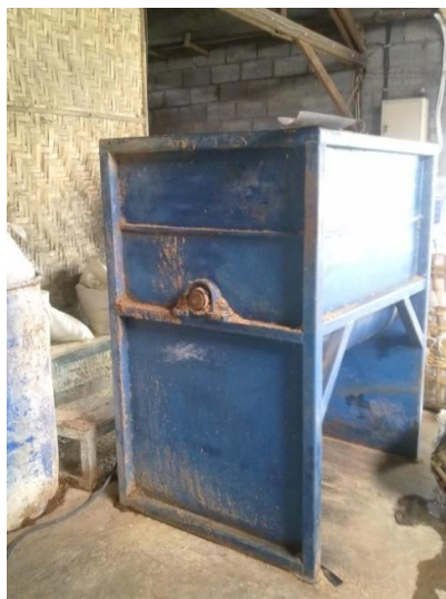
Gambar11. Mesin mixer bahan
