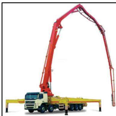
*Gambar 2.12. Concrete Pump*
