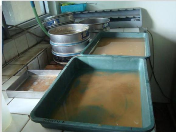
Gambar 18. Foto proses fraksionasi bahan organik tanah menggunakan metode ayakan basah
