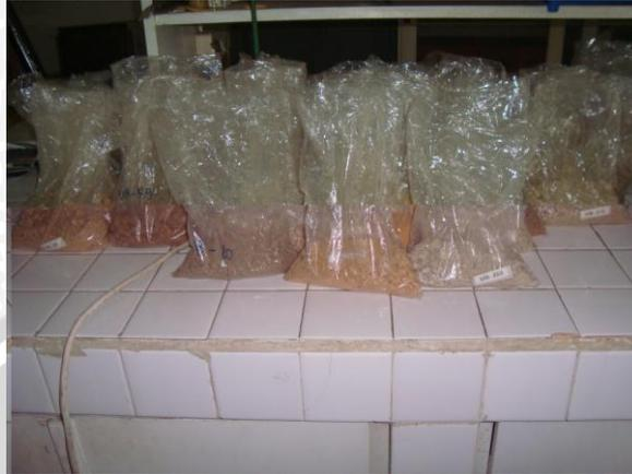
Gambar 17. Foto penimbangan berat kering sampel tanah sebelum difraksionasi
