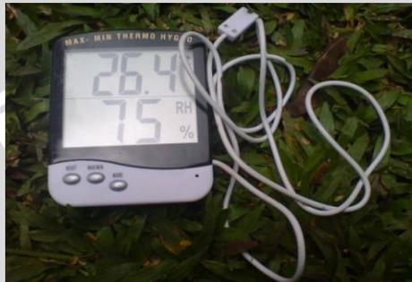
Gambar 11. *Thermohygrometer* Tipe TA218c yang Digunakan dalam Pengamatan.
