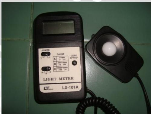
Gambar 10. *Lighmeter* Tipe LX-101A yang Digunakan untuk Mendapatkan Nilai Transmisi Cahaya
