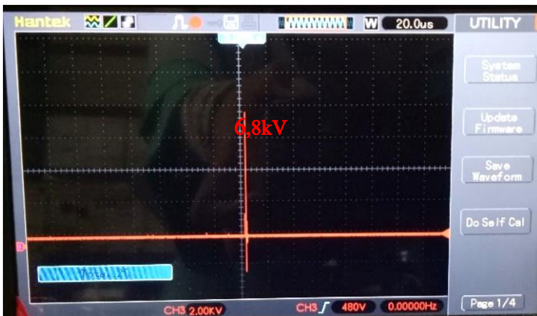
Gambar 5.4. Hasil Pengujian Setelah Resistor Diganti Menjadi 1 MΩ 1 W.
