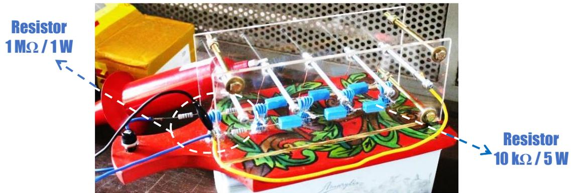
Gambar 5.2. Rangkaian Marx Generator Pengujian Kedua Tanpa Beban
