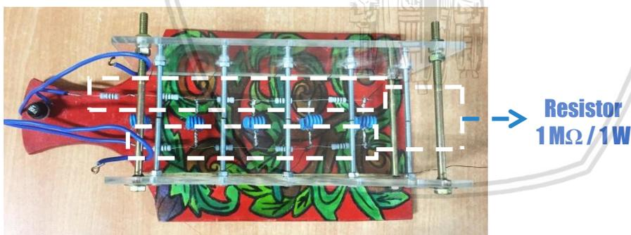
Gambar 5.6. Rangkaian *Marx Generator* Pengujian Kedua dengan *Storage Capacitor*
