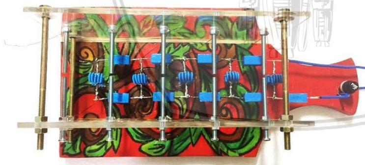
Gambar 5.1. Rangkaian *Marx Generator* Pengujian Pertama Tanpa Beban
