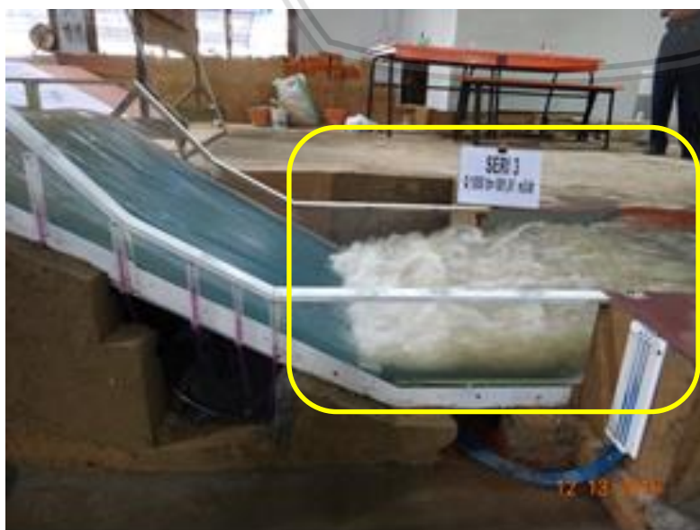
Gambar 1.4 Kondisi aliran hidraulik pada peredam energi II debit Q_{1000th}
