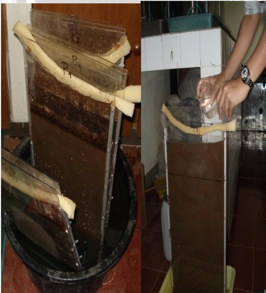
Perendaman *planar cage* dalam bak dan penyiraman dari atas hingga kapasitas lapang
