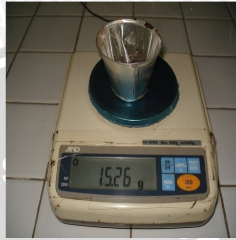
Keterangan: kascing ditimbang setelah di oven
