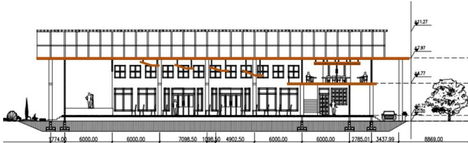
Lampiran 4.15 Potongan A-A' penambahan bentuk plafond gantung lapis plasterboard (alternatif 6) pada Ballroom dan Meeting Room Hotel Paseban Sena Kota Probolinggo
