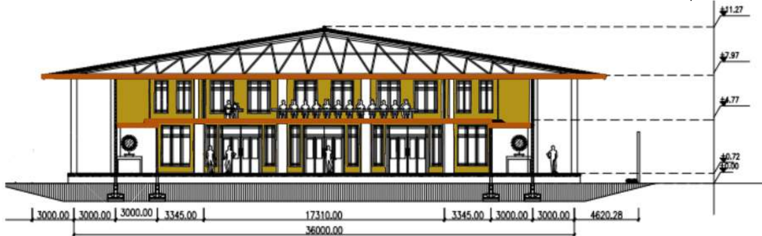
Lampiran 4.9 Potongan B-B' penambahan material softboard pada dinding dan plywood pada plafond (Alternatif 4) di Meeting Room
