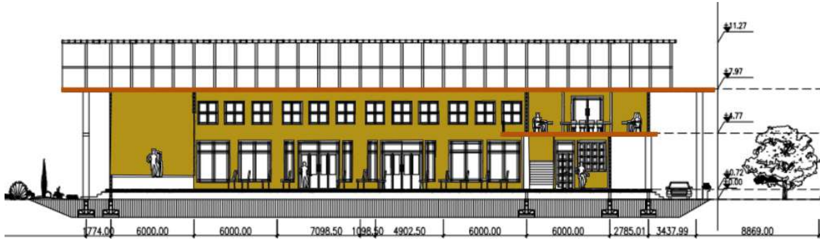
Lampiran 4.8 Potongan A-A' penambahan material softboard pada dinding dan plywood pada plafond (Alternatif 4) di Meeting Room
