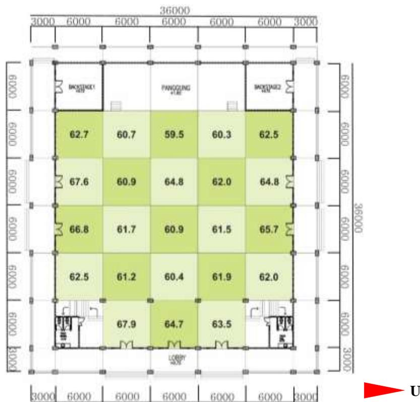
Gambar 4.14 Hasil pengukuran *background noise level* pada *ballroom* lantai satu
