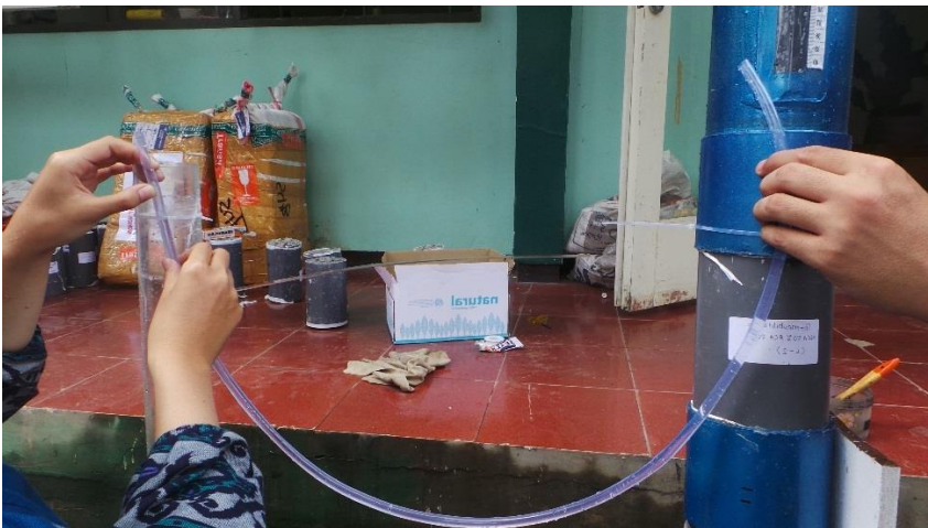
Gambar 4.4 Mengukur tinggi permukaan beton porous pada pipa kanan alat uji
