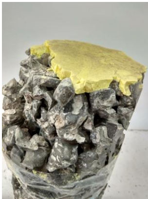
Gambar 4.12 Beton porous setelah diuji kuat tekan
