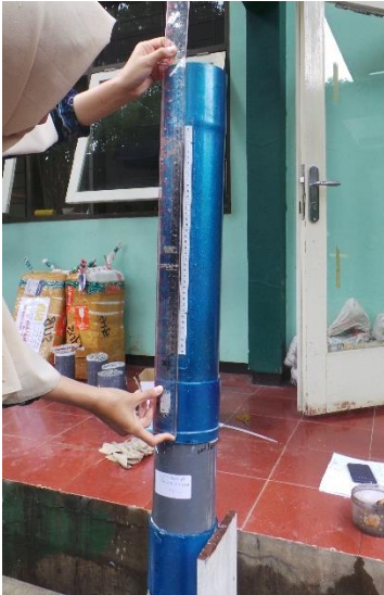
Gambar 4.5 Mengukur tinggi awal air dari permukaan beton
