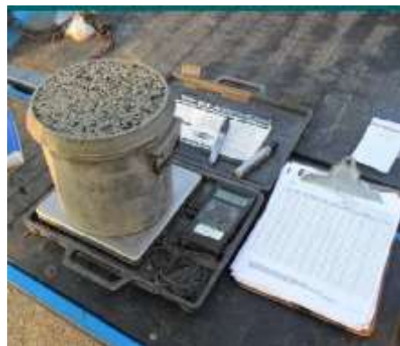
Gambar 2.11 pengukuran density dalam kondisi freshly mixed
