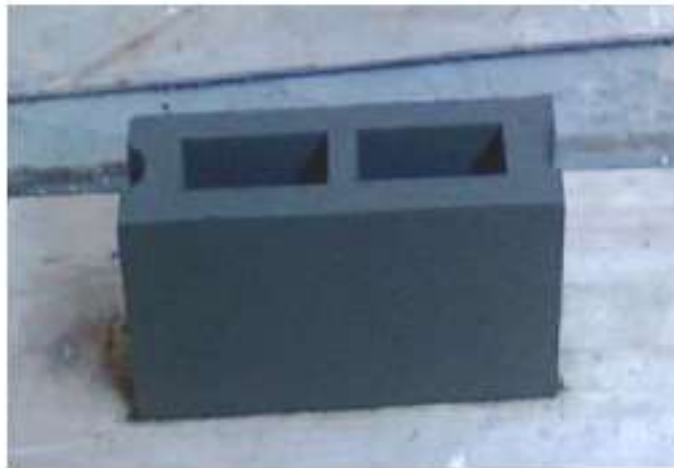
Gambar 2.1 Bata Beton Berlubang setelah dilepas dari bekisting
