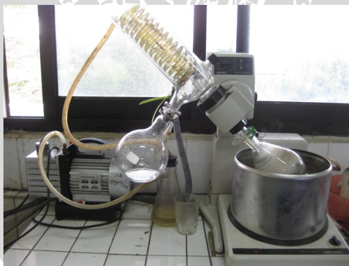
Gambar 5. Pompa Vakum Evaporator.
