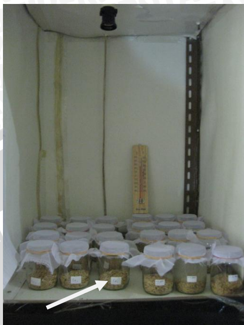
Gambar 8. Tabung Kaca Transparan yang Digunakan pada Perlakuan Fumigan Tablet Berbasis Minyak Mimba ( t=9 cm dan d=6,5 cm)
