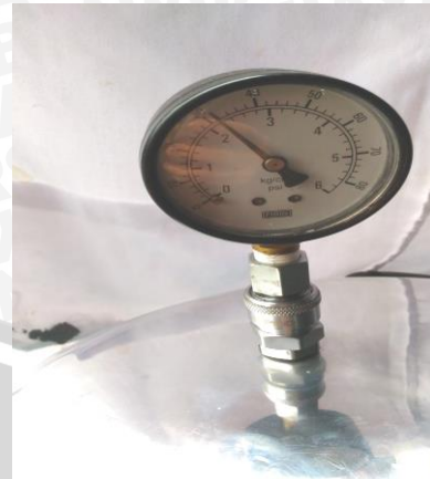
Ket 3.5 mengatur tekanan pada 2.2 atm selama 10 menit pada masing-masing kelompok perlakuan
