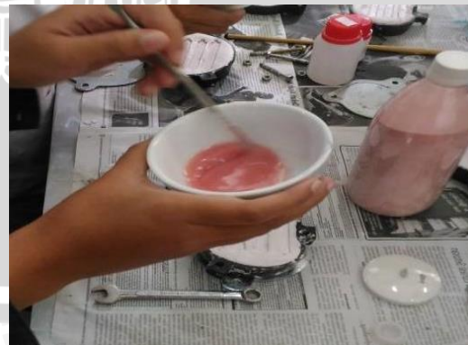
Ket 3,1 manipulasi dan pengadukan resin akrilik cold cured
