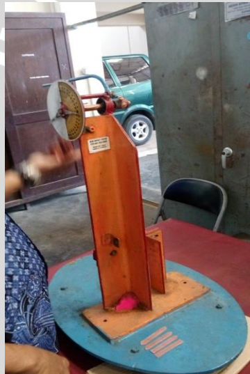
Ket 4.2 Pengujian kekuatan impact. Bandul diayunkan pada sudut awal \alpha ( 90^\circ ) lalu bandul akan tetap berayun pada sudut \beta setelah menghatam spesimen
