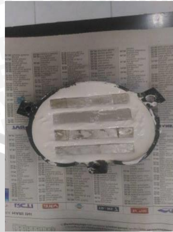
Ket 2.5 Aplikasi master model pada cetakan gips
