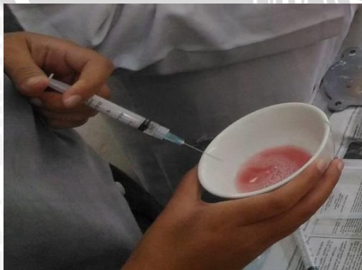
Ket 3,1 manipulasi dan pengadukan resin akrilik cold cured
