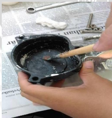
Ket 2.2 Mengulasi seluruh permukaan kuvet dengan vaselin
