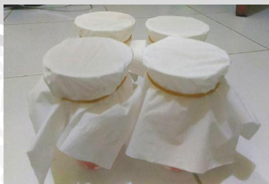
Ket 3.8 melakukan perendaman resin akrilik cold cured dalam larutan aquades selama 48 jam
