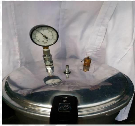
Ket 3.5 mengatur tekanan pada 2.2 atm selama 10 menit pada masing-masing kelompok perlakuan
