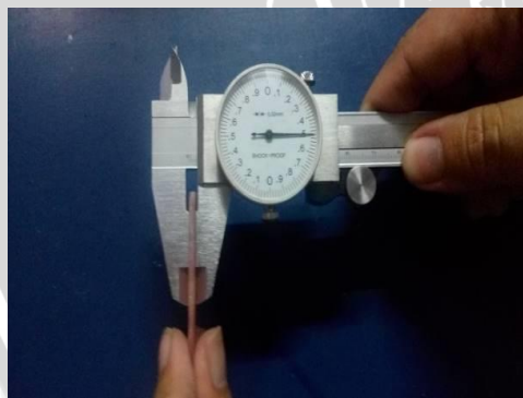
Ket 3.7 mengukur dimensi resin akrilik cold cured
