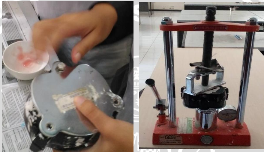
Ket 3.3 menutup kuvet lawan dan press menggunakan hydrolic press lalu tunggu sampai 5 menit
