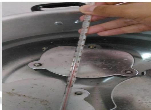
Ket 3.4 mengatur suhu air pada 30°C, 40°C dan 50°C
