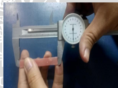
Ket 3.7 mengukur dimensi resin akrilik cold cured
