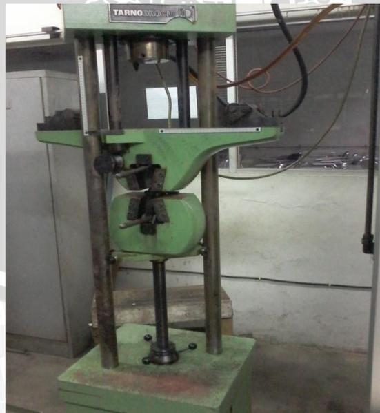
Gambar 2.2: Alat *Universal Testing Machine Type PM 100 Tarno Grocky* (Sumber: laboratorium teknik mesin Politeknik Negeri Malang)
