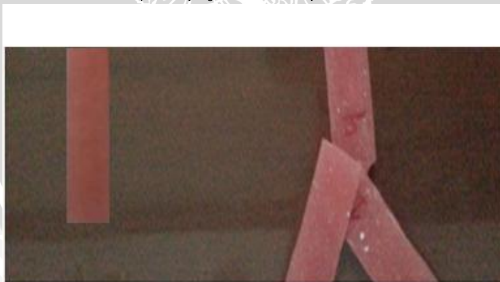
Gambar 7.7: Spesimen yang belum dilakukan uji kekuatan transversa
